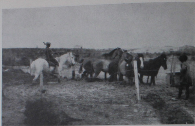
Puerto Madrynin pienen kaupungin laidassa hevoset ja muuut sokevat tiilitehtaanseen savea. (Valok. V. A.)
